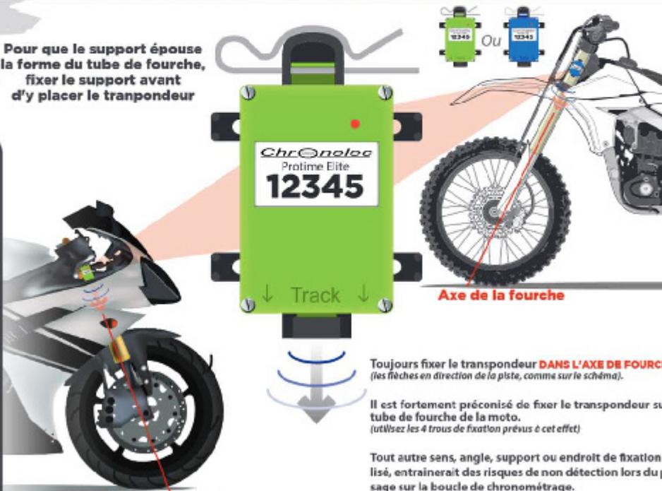
Toujours fixer le transpondeur **DANS L'AXE DE FOURCHE**. (les flèches en direction de la piste, comme sur le schéma).
