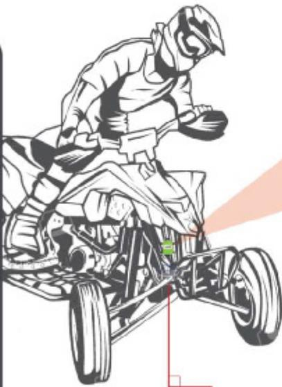
Toujours fixer le transpondeur à **90°** du sol (les flèches en direction de la piste, comme sur le schéma).
