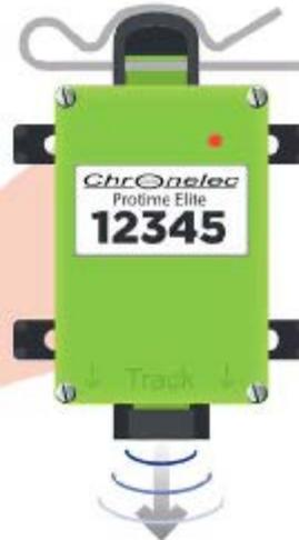
Toujours fixer le transpondeur à **90°** du sol (les flèches en direction de la piste, comme sur le schéma).
