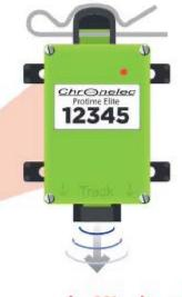
Toujours fixer le transpondeur à (les flèches en direction de la piste, comme sur le schéma).
